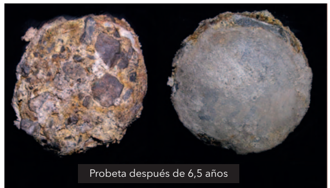
Hormigón no tratado
