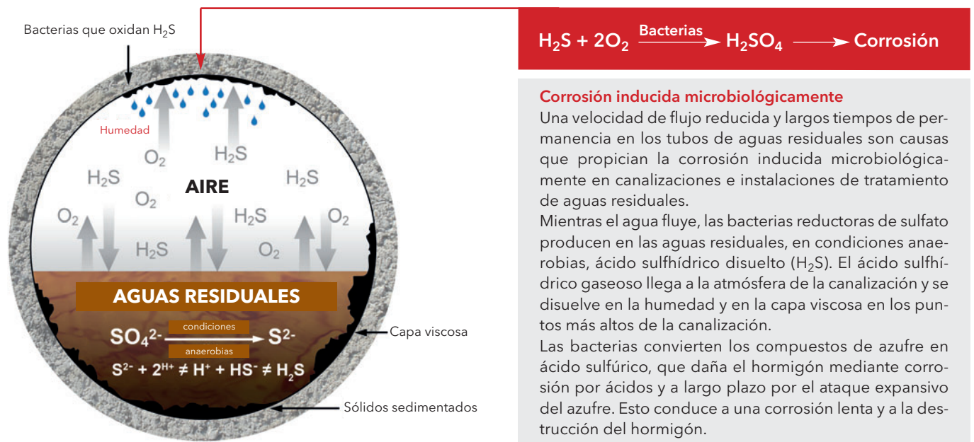
Fig. 1: La corrosión inducida microbiológicamente (MIC) es un proceso bioquímico complejo, en el que se generan ácidos fuertes que destruyen rápidamente el hormigón y el acero.
